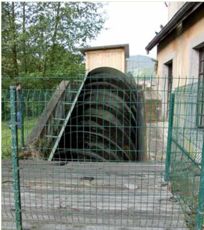
Turbine lente de type « Vis sans fin »
